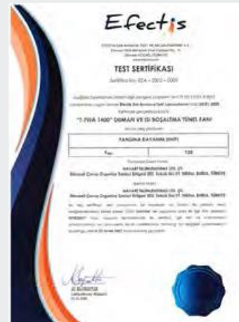
T-FWA Tunnel Jet Fan F400 2H EN 12101-3
